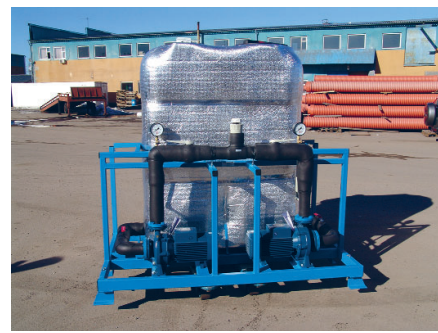
Рис. 5. Гидро модуль на 2-х насосах с аккумуляторным баком
