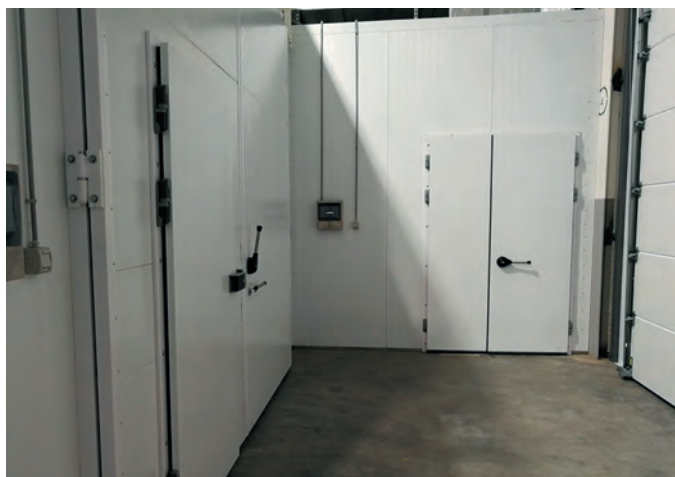
Испытательный комплекс из двух климатических камер
