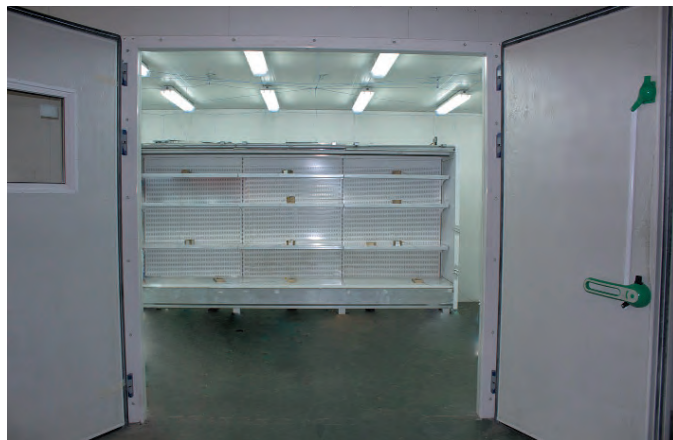
Холодильная витрина в климатической испытательной камере
