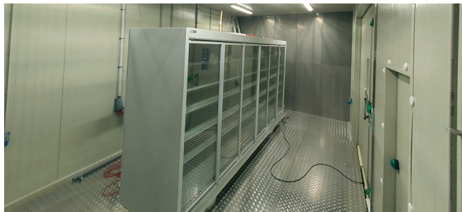
Холодильная витрина загружена в камеру для испытаний
