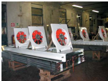
Воздухоохладители CROCCO с вентиляторами на откидных панелях
