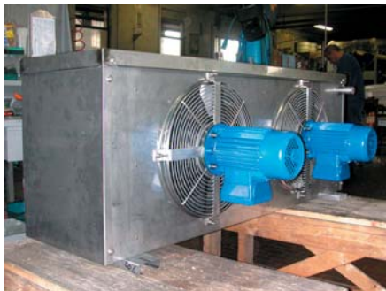
Воздухоохладитель CROCCO из нержавеющей стали во взрывозащищенном исполнении
