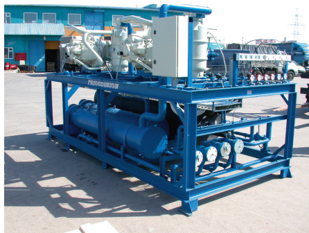
Рис. 3. Холодильная установка производительностью 1,2 мВт для получения ледяной воды непосредственным охлаждением в испарителе
