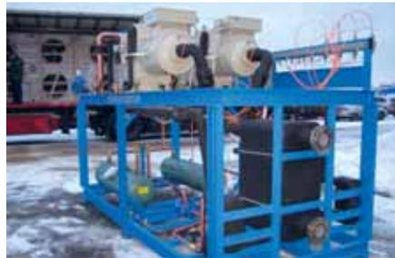
Изготовлен и поставлен chillер холодопроизводительностью 300 кВт для охлаждения масла в разборном пластинчатом теплообменнике и хранения охлажденного масла в двух кристаллизаторах. Охлаждение масла с производительностью 140 т/сутки осуществляется с температуры +50°C до +4...+6°C.
