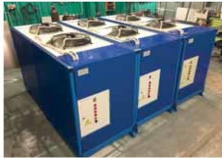
В рамках технического перевооружения изготовлены три холодильных агрегата для системы кондиционирования цеха, поддерживающих постоянную температуру +12°C внутри него.
