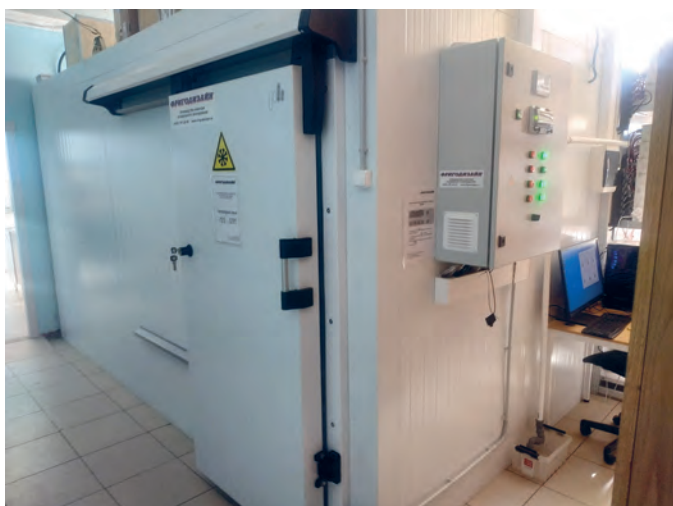
Камера для испытаний мерзлых грунтов (снаружи)
