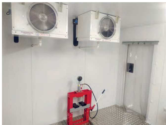
Камера для испытаний мерзлых грунтов (внутри)
