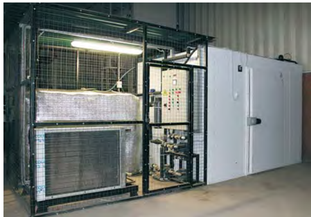
Рис. 3. Испытательная камера с машинным отделением в собранном виде
