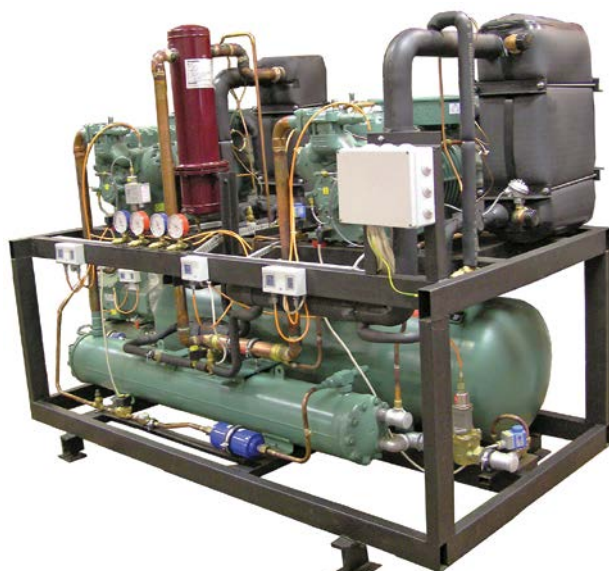
Двухкаскадная холодильная установка для охлаждения хладагента до -80°C
