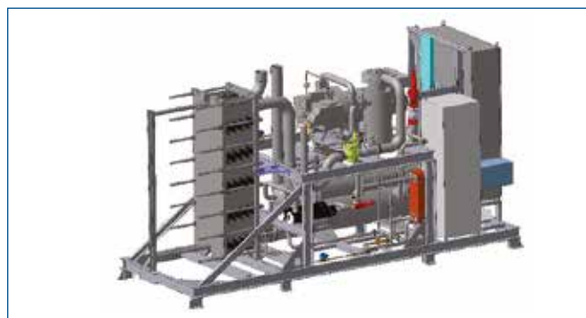
Рис. 2. Конструкторская проработка компоновки установки ледяной воды
