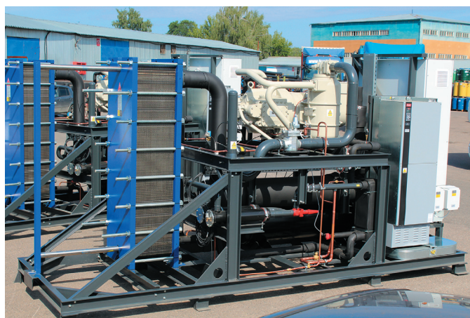
Партия генераторов ледяной воды с пластинчатыми испарителями перед отгрузкой заказчику
