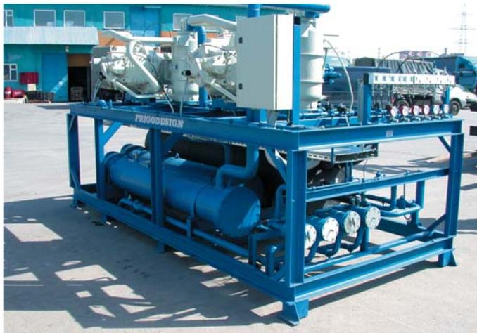
Холодильная установка ГК «ФРИГОДИЗАЙН» на компрессорах J&E Hall обеспечивает температуру ледяной воды 1-2°C на выходе из кожухотрубного испарителя и имеет холодопроизводительность 1100 кВт при температуре окружающего воздуха +30°C. Суммарное энергопотребление компрессоров, насосов и вентиляторов составило 279 кВт, при этом коэффициент COP компрессоров (аналог КПД) достигает 4,6.
